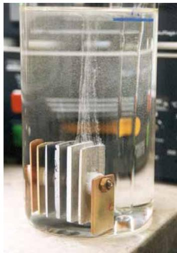
Abb. 1: Statische Korrosion gemäß ASTM D 1384
