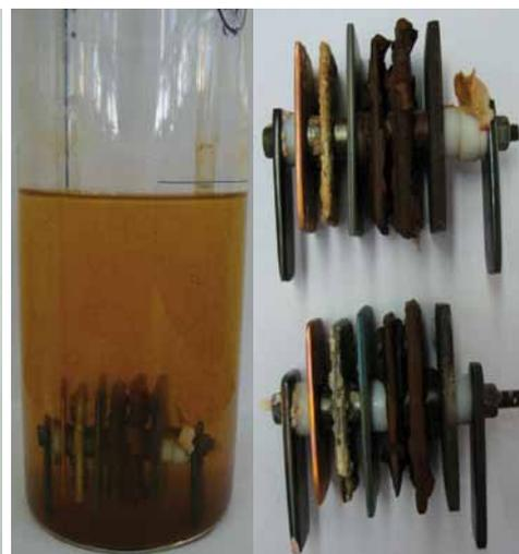
Abb.2b: MEG-Wassergemisch ohne Korrosionsschutz nach ASTM D 1384
