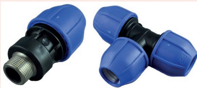
Gase, Flüssigkeiten und Feststoffe können mit wenigen Handgriffen auch bei beengten Platzverhältnissen verbunden werden. Die Rohrenden müssen dazu vorher nicht bearbeitet werden. Die Verbindungselemente tragen dazu bei, Zeit und Kosten der Montage deutlich zu reduzieren, da zusätzliche Aufwendungen wie Verschweißen oder Verzinken wegfallen. Zudem lassen sich die
