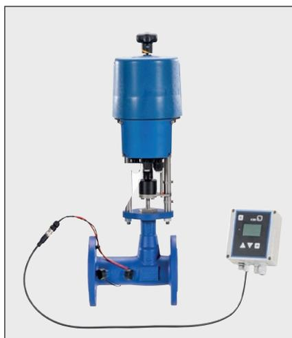
Abb.6: Zusammen mit einem Stellantrieb mit integriertem Prozessregler bildet die Ausführung BOA-CVE Control IMS einen autarken Regelkreis für die automatisierte Sollwert-Ausregelung der Regelstrecke.
