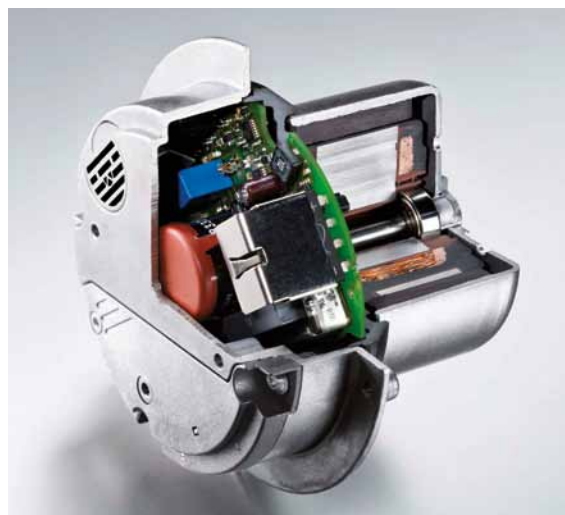
Abb.1: EC Motoren sind kollektorlose Gleichstrommotoren mit Nebenschlusscharakteristik, die speziell für den Einsatz in Lüftungs- und Klimatechnischen Anlagen entwickelt wurden.
