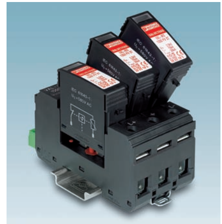
Abb.3: Steckbare Schutzmodule mit Statusanzeige ermöglichen die Überprüfung der Funktion sowie den leichten Austausch im Defektfall – hier das Überspannungsschutz-Modul „VAL-MS 1000/2+V“ (Class 2) für PV-Anlagen bis 1000 Volt DC
