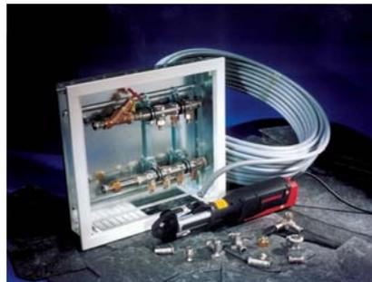
Edelstahl ist mit nur sieben Formteilen in allen gängigen Trinkwasserversorgungen anwendbar - über die Verteilerstation im Wandgehäuse oder die T-Stück-Installation mit 15/12/15er Anschlüssen. Zweifel an einer zu schwachen Dimensionierung sind aufgrund zahlreicher Messergebnisse unbegründet: Der Außendurchmesser beträgt 15 mm bei einer Wanddicke von insgesamt 1,6 mm (Summe aus Inliner, Haftvermittler und
