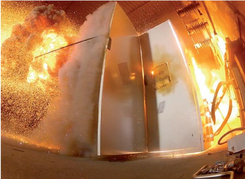
Störlichtbögen können explosionsartig zerstörerische Kräfte freisetzen. Damit stellen sie eine große Gefahr für Menschen und Anlagen dar. Um teure Anlagenausfälle, Brände und Personenschäden zu verhindern, sind bereits bei der Planung und Projektierung geeignete Schutzmaßnahmen vorzusehen. Der folgende Beitrag zeigt unter Berücksichtigung der aktuellen Normenlage auf, welche Schutzmaßnahmen für einen sicheren Betrieb und eine hohe Anlagenverfügbarkeit zu ergreifen sind.
