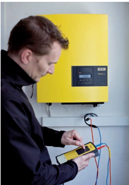
Abb. 1: Mit Kennlinienmessgeräten wie dem TRI-KA von TRITEC werden Leerlaufspannung und Kurzschlussstrom gemessen und daraus die STC-Kennlinie ermittelt.
