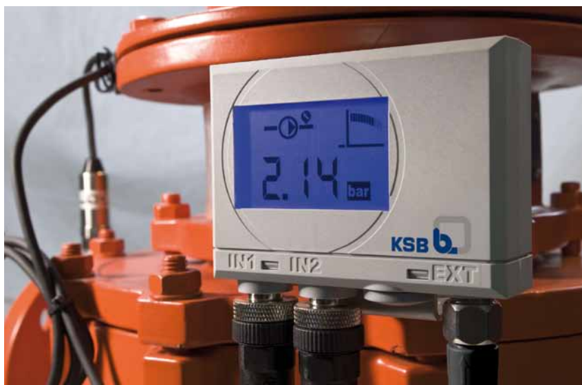
Abb.2: Die Überwachungseinheit PumpMeter ermittelt den tatsächlichen Betriebspunkt der Pumpe und wird bei KSB werkseitig vormontiert. Damit sieht der Anlagenbetreiber auf einen Blick, ob die Pumpe effizient arbeitet.
