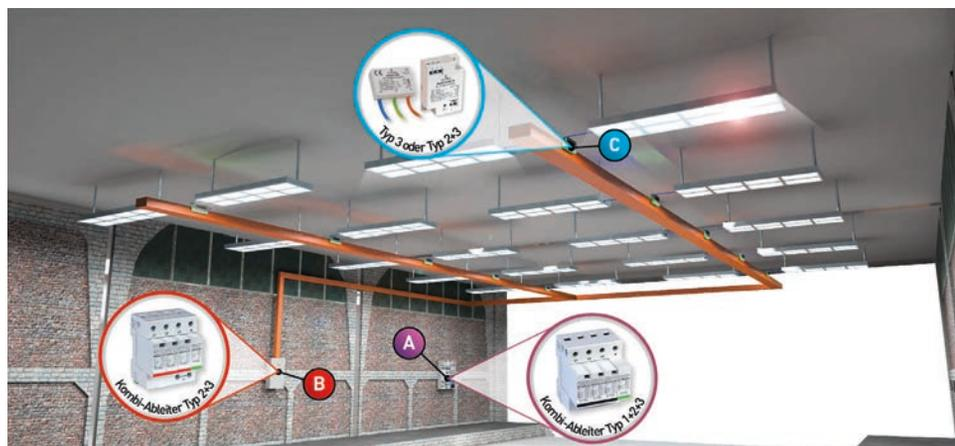
Abb. 1: Schutz einer Industriehalle: A) Einspeisung, B) Beleuchtungs-UV, C) Leuchtenstromkreis
