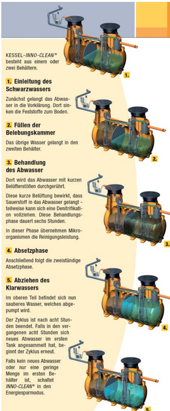
Abb.2 Ablauf der Abwasserreinigung
