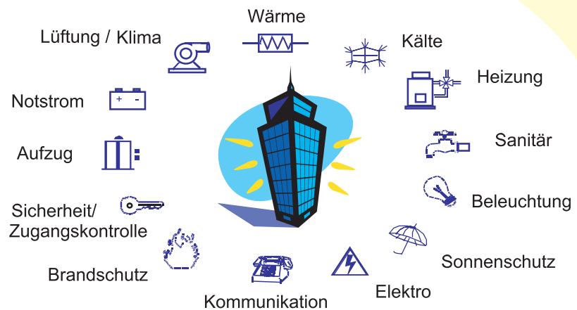
Abb.1 Gewerkeübergreifende und gewerkeintegrierende Gebäudeautomation als ganzheitliche Aufgabe Grafik Prof. Dr. Martin Becker
