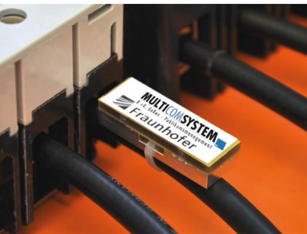
*Einfaches Anbringen vom RFID Transponder an dem zu überwachenden Kabel*
