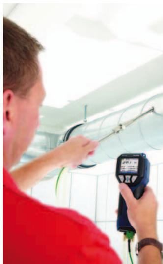
Abb.5: Messen der Strömungsgeschwindigkeit mit dem dem Wöhler DC 410
