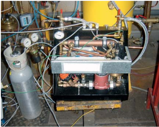
Abb.2 Instrument zur Online-Messung der Konzentration gelöster Gase
