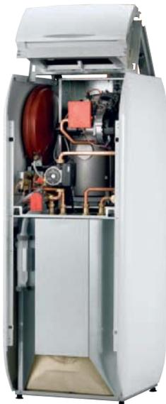
Platz sparende Installation bei Neubau und Modernisierungsmaßnahmen. Bei beiden Leistungsversionen (15 und 25kW) ist im unteren Teil der Heizzentrale ein 130 Liter Hochleistungsspeicher untergebracht. Eine Titan-Schutzanode (TSA) verhindert Korrosion und sichert so langfristig die hygienische Warmwasserbereitung.
