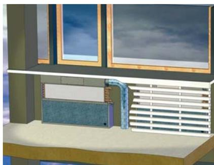
Der Primärluft-Volumenstrom beträgt 30 - 80 m<sup>3</sup>/h bei einer Kühlleistung bis max. 500 W sowie einer Heizleistung bis max. 450 W.
