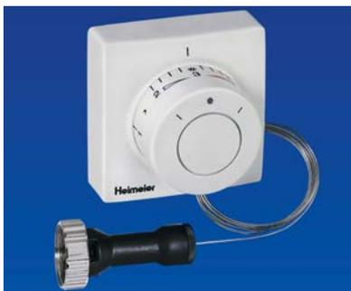
traleinsteller). Geeignet ist er außerdem für Sonderanwendungen in Schwimmhallen oder medizinischen Einrichtungen. Eine exakte Skalierung sorgt für präzise Temperatureinstellungen. Das Regelverhalten zeichnet sich durch hohe Stellkraft, geringe Hysterese und optimale Schließzeiten aus. Der Kopf ist für Montage auf ebener Wand, herkömmlichen Schalterdosen oder Brüstungskanälen vorgesehen. Das Kapillarrohr kann durch ein
