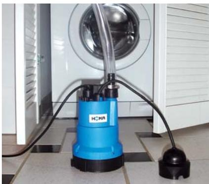
Dabei schafft sie bis zu 6000 Liter verschmutztes Wasser mit Festanteilen bis zu 4 mm Korngröße in der Stunde. Homa garantiert die Funktionsfähigkeit der nur 4,2 kg leichten Pumpe bis zu einer maximalen Temperatur des Fördermediums von 35° C, kurzfristig sind bis 60° C möglich. Der Kühlmantel mit oberem Druckanschluss sorgt im Schlüfbbetrieb für eine ausreichende Motorkühlung. Abgepumptes Wasser fließt um das Aggregat herum und schützt das Gerät so vor Überhitzung.
