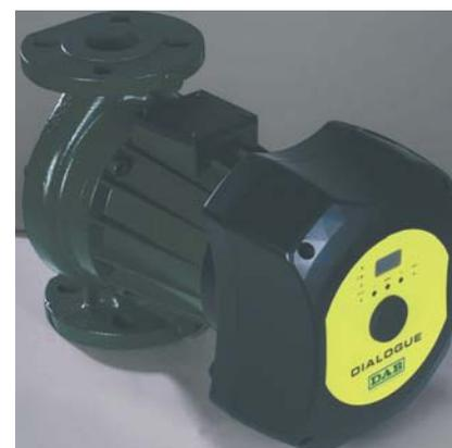
weswegen Förderhöhen von bis zu 12 m und Fördermengen bis zu 60 m³/h erreicht werden. Die Pumpen mit Flansch tragen die technische Bezeichnung BPH-E in der Einzel- bzw. DPH-E in der Doppelversion.
