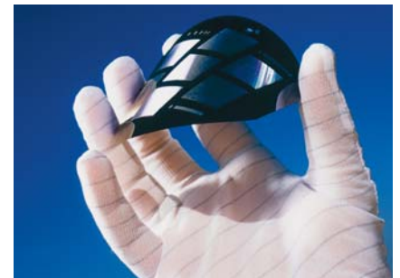
Abb.2 Si-Solarzelle auf 40 \mu\text{m} -Wafer: 20 %
