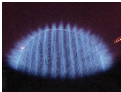
Abb.4 RX-350-Flammkopf: Minimale (ca. 50 kW) und maximale Wärmebelastung (ca. 350 kW)
