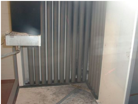
Abb. 5: Der SBI-Test – hier mit Elastomer-Schläuchen dargestellt vor, während und nach dem Test
