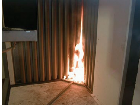
Abb. 5: Der SBI-Test – hier mit Elastomer-Schläuchen dargestellt vor, während und nach dem Test
