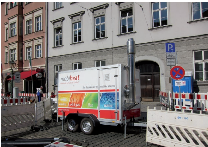
Abb. 1: Mobile Heizung MH300F bei einem Notfalleinsatz in einem Stadtgebiet. Das Gebäude wird mit einer Leistung von 300 kW mit Heizwärme versorgt. Zusätzlich ist ein Kamin-Abgasschalldämpfer montiert.
