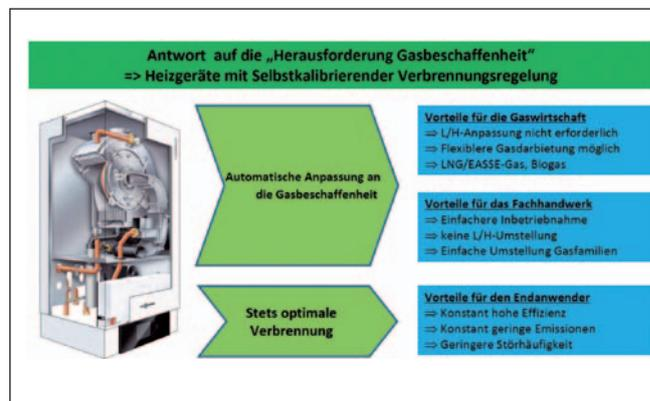
Abb.8: Von den Vorteilen der selbstkalibrierenden Verbrennungsregelung profitieren Gaswirtschaft, Fachhandwerk und Anlagenbetreiber gleichermaßen.
