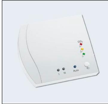
Abb.3 : Der CO<sub>2</sub>-Gehalt der Luft wird bei Raumtemperatur- und CO<sub>2</sub>-Messumformern, wie dem AERASGARD® RTM-CO<sub>2</sub> 2S, mittels nicht dispersiver Infrarottechnologie (NDIR-Sensor) ermittelt.
