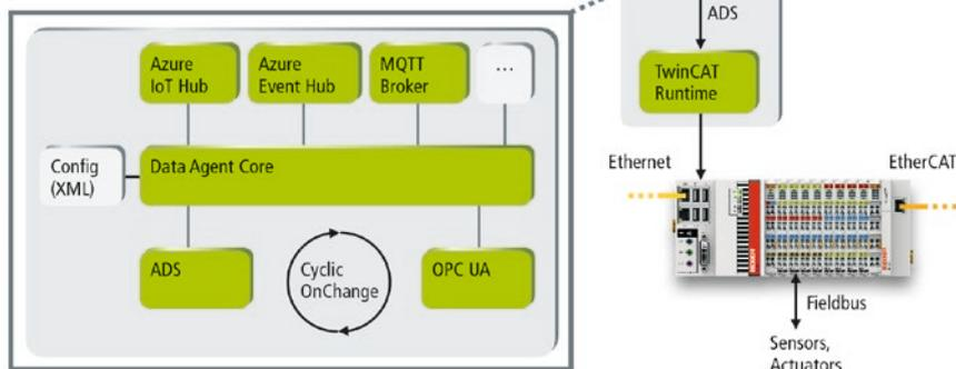
Abb. 3: Durch die Publisher/Subscriber-Kommunikationsmechanismen und die Kommunikation über den Azure IoT Hub als zentralen Nachrichten-Broker müssen alle an der Kommunikation beteiligten Geräte oder Dienste untereinander keine gegenseitige Adressbekanntgabe durchführen, sondern sie kommunizieren entkoppelt voneinander über den zentralen Broker.
