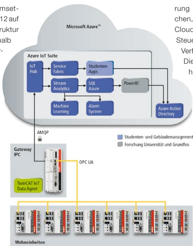
Abb. 1: Ein zentraler Beckhoff Industrie-PC sammelt die Sensordaten der einzelnen Wohneinheiten mit Hilfe des TwinCAT IoT Data Agent über OPC UA ein und fungiert als Gateway zur Microsoft Azure™ Cloud.
