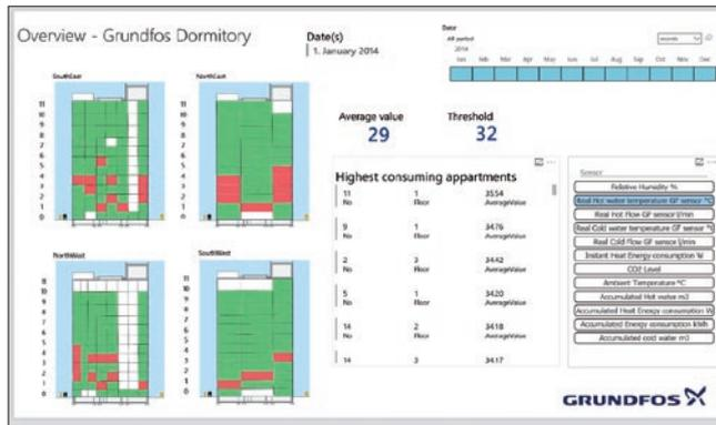
Abb. 2: Das Energiemonitoring-System wird für die Speicherung und Analyse aller Energieverbrauchsdaten der insgesamt 156 Wohneinheiten sowie für das Alarmmanagement genutzt.
