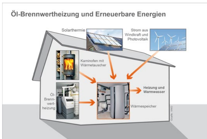
Abb.3: Eine Hybridheizung ist effizient und zuverlässig. Sie verteilt die Wärmever-sorgung auf mehrere Säulen. Künftig kann dazu auch die Einbindung von über-schüssigem Strom gehören.
