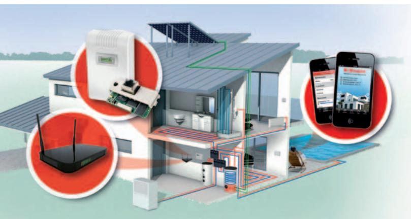
Wärmepumpen als Bestandteil moderner Haustechnik werden heute zunehmend in die Netzwerke der Gebäudeautomation eingebunden. Zur Anbindung an die Gebäudeleittechnik stellt Dimplex verschiedene Erweiterungsmodul für den Wärmepumpenmanager zur Verfügung. Der Installateur oder auch Hausbesitzer ist damit in der Lage, die Wärmepumpe z.B. über eine Ethernet oder KNX/EIB-Verbindung anzusteuern oder die Betriebsdaten mit Hilfe eines Smartphones auszulesen.
