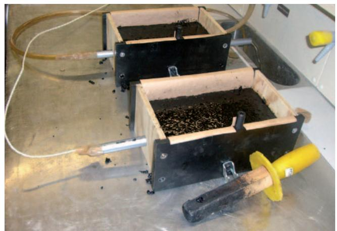
Abb.4: PE-Xa/Aluminium/PE-HD und PE-Xa/PE-HD in Gussasphalt bei 240°C
