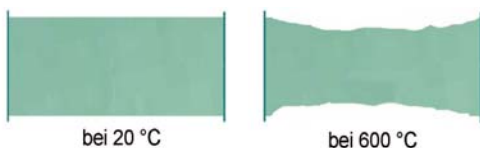
Abb.3 Kanal ohne Aussteifung
