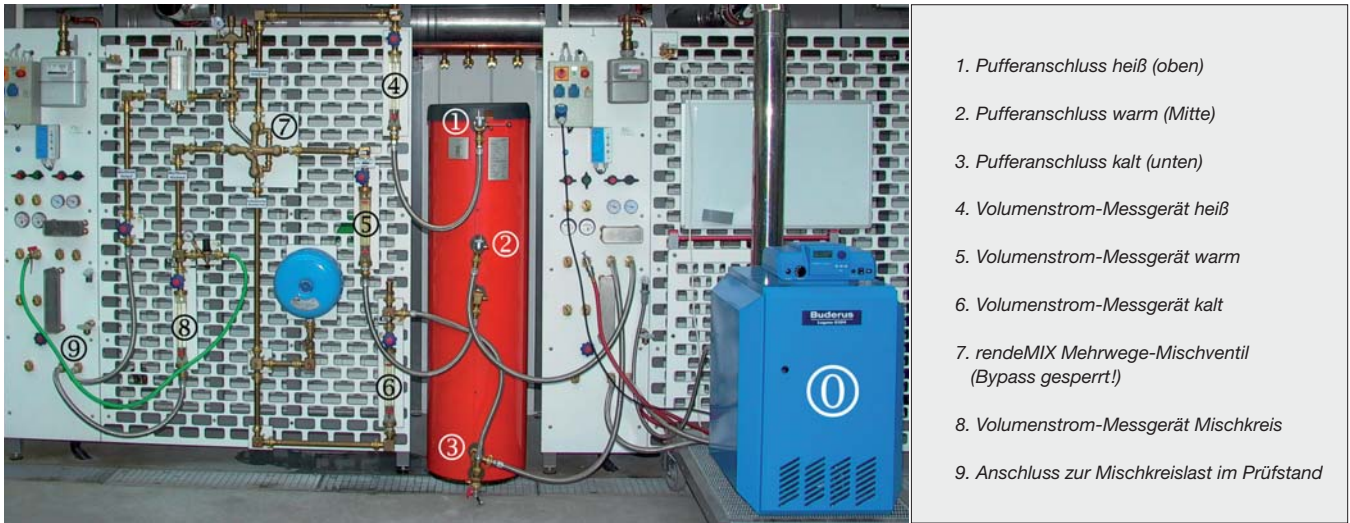
Abb.5 Versuchsaufbau der Speicherentladung
