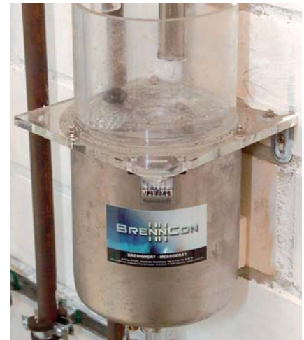
Abb.2 Durch Kondensaterfassung (hier: Fabrikat „BrenCon“) läßt sich der Wirkungsgrad von Brennwertanlagen leicht überwachen
