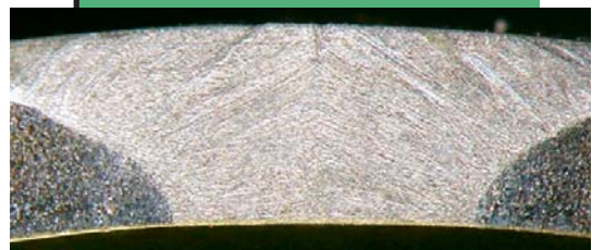
Schweißnaht im Querschliff, Ausführung Wolfram-Inert-Gas (WIG), geglättet, geglüht
