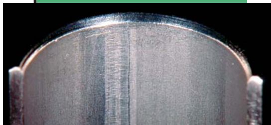
Schweißnaht-Innenansicht eines halbgelassenen Rohres 15 x 1 mm. Die geglättete WIG-Schweißnaht ist nur an den Schmelzlinien und durch die Farbmarkierung des Glättwerkzeuges zu erkennen
