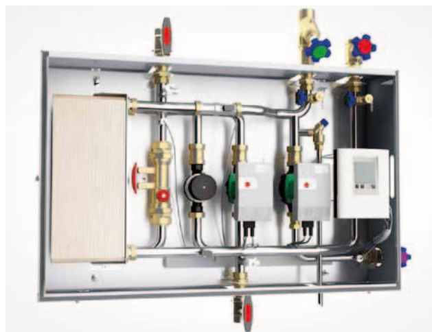
Abb. 1: Die Frischwasserstation TacoTherm Fresh 120 liefert hohe Warmwasserleistungen bei gleichzeitig gradgenauer Entnahmetemperatur auch bei geringsten Zapfmengen. Die Hauptbestandteile der anschlussfertigen und steckerfertig vedrahteten Station sind ein Plattenwärmetauscher, modulierende Umwälzpumpen und eine elektronische Regelung mit Display.
