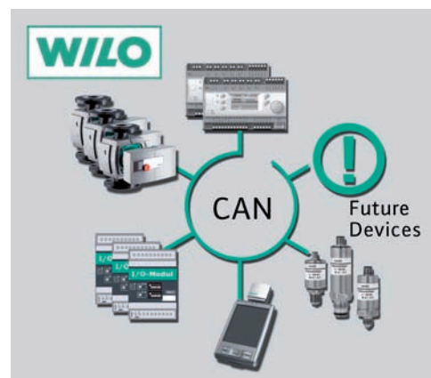
Abb.5 Die wesentlich schnellere und offene CAN-Technologie lässt sich mit allen Systemen und Komponenten kombinieren.
