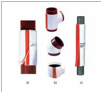
Abb. 6: Brandschutz-Dämm-Manschetten MSA4-BSM, BSM-S mit integrierter Körperschalldämmung. Sie werden verwendet für nicht brennbare Abwasserleitungen aus Gusseisen und Stahl bis 160 mm, für Sanitär- und Heizungsrohrleitungen, Gasleitungen, Siederohre, Feuerlöschleitungen usw. aus Stahl und Kupfer bis 160 mm sowie für Kunststoff- und Mehrschichtverbundrohre bis 32 mm.
