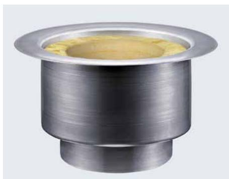
Abb.2: Mit dem nach DIN 18234 geprüften Brandschutzelement werden die Anforderungen an Rohrdurchführungen gemäß der Industriebaurichtlinie erfüllt. Sowohl der Dachablauf als auch die weiterführende Entwässerungsleitung können dabei aus Kunststoff bestehen.
