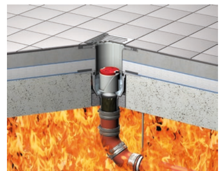
Abb. 3: Bodenablauf Feuer unten
