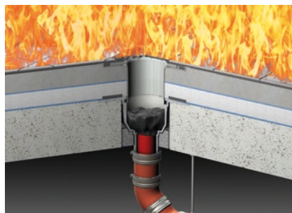
Abb. 2: Bodenablauf Feuer oben
