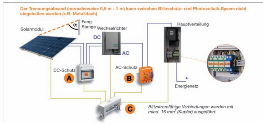
Abb.4: Einsatz von blitzstromtragfähigen Ableitern
