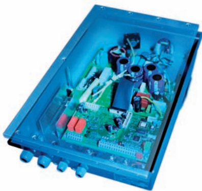
Abb. 5: Frequenzumrichter Icontrol flat in extra flachem Design (links). Er kann direkt beim Ventilator in Lüftungsgeräten untergebracht werden (rechts).
