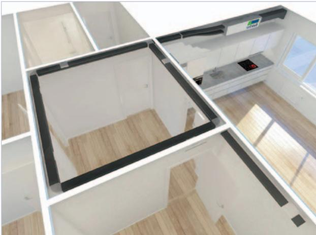
Abb.5: Systemaufbau der Komfortlüftung refresh
