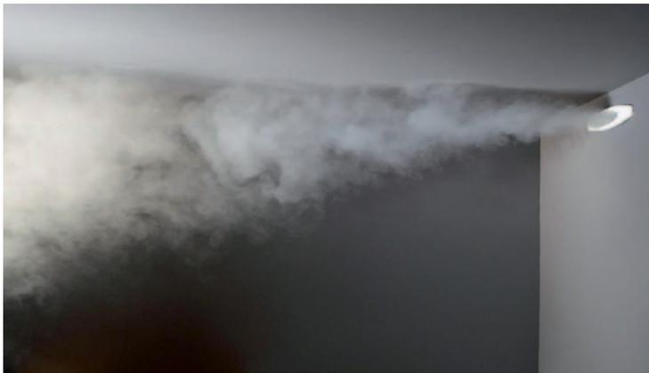
Abb.7: Der Coanda-Effekt sorgt für vertikale und horizontale Flächenabdeckung
