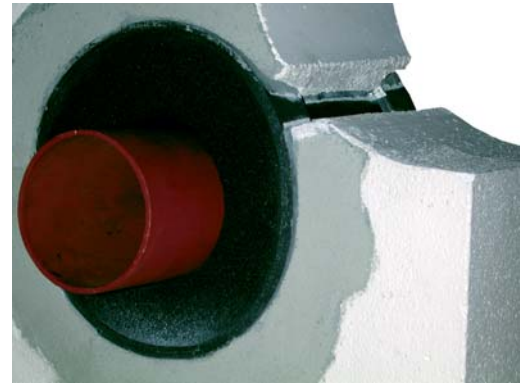
Abb.2 Muster der Durchführung mit dem Brandschutzstreifen (S)
