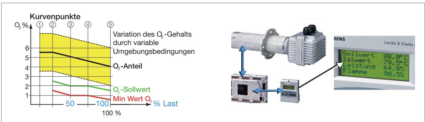
Abb.4 Der Brenner RS 300-400-500/EV BLU lässt sich optional zur zusätzlichen Effizienzsteigerung mit Restsauerstoff-Regelung nutzen. Die im Abgasweg installierte Zirkonoxid-Sonde kommuniziert direkt mit dem Feuerungsmanager
