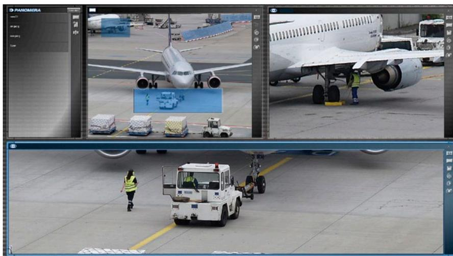
Abb.2: Das Seitenverhältnis kann bei Multifocal-Sensorsystemen der jeweiligen Situation angepasst werden und ist nicht an feste Formate wie 16:9 oder 4:3 gebunden.
