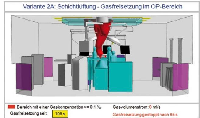
Abb. 8: Gasverteilung im Raum bei Luftzuführung über Schichtdurchlässe 105 s nach Freisetzung
