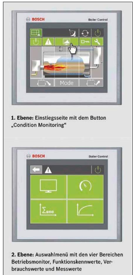
Abb.6: Bosch Kesselsteuerung mit Condition Monitoring für eine gleichbleibend hohe Effizienz und Verfügbarkeit
