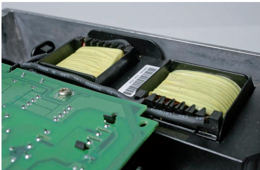
Abb.4: Eingebaute Drosseln reduzieren die Netzrückwirkungen und schützen die Kondensatorarten des Zwischenkreises
