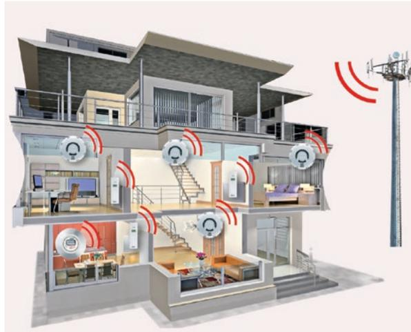
Abb.2: Integration des Funk-Rauchwarnmelders in das Minol-Funksystem
