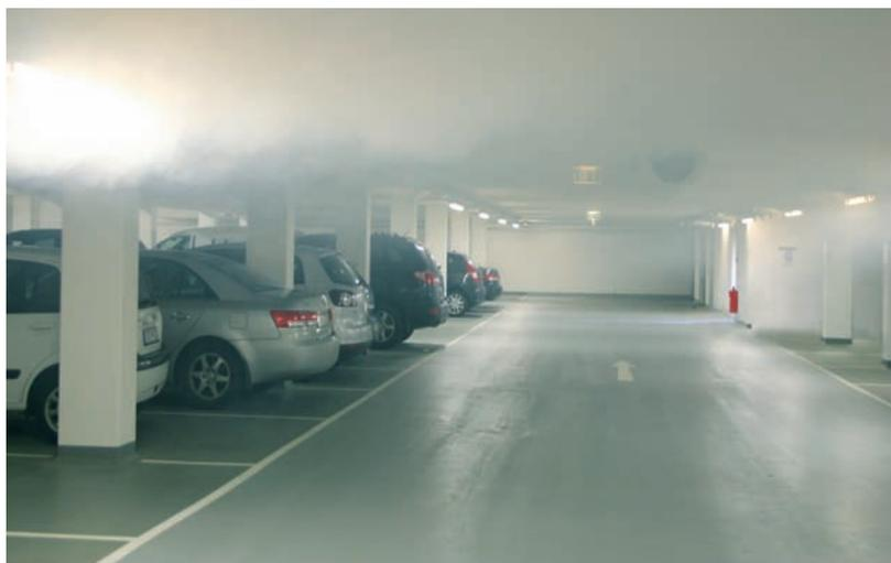
Abb.10: Der Rauch verteilt sich gleichmäßig unterhalb der Decke und die Ventilatoren sind in Betrieb. Rauchversuche: Tiefgarage der Europazentrale von Hyundai
